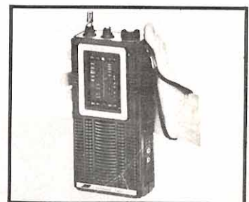
Receptor multibandas FM 26-28 Mhz. 54-87 Mhz. 88-176 Mhz. Ideal para recibir las microemisoras. Squelch. Excelente sensibilidad. 20 x 10 x 5 cm.
